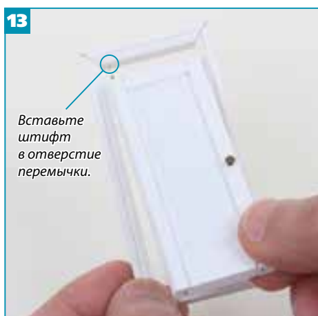
13 В отверстие перемычки дверной коробки, собранной вами в шаге 11, вставьте свободный конец штифта, который вы закрепили в двери в шаге 12.
