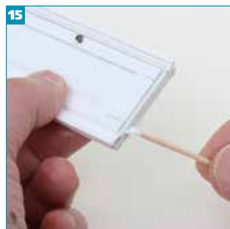
15 Чтобы штифт не выпал, при помощи зубочистки нанесите на место крепления немного клея.
